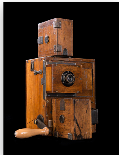
COLLECTION GAUMONT / CAMÉRA RÉVERSIBLE CHRONOPHOTOGRAPHIE SYSTÈME G. DEMENY, FABRICANT L. GAUMONT & CIE (1897) / PHOTOGRAPHIE NICOLAS MATHÉUS
